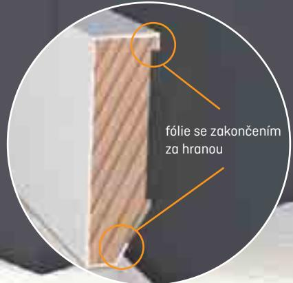
Nové dřevěné lišty firmy Döllken Profiles jsou jedinečné. Kvalitní jádra ze smrkového dřeva jsou opláštěny fólií Polyblend neobsahující chlór na bázi polypropylenu. Díky tomu jsou lišty velmi robustní a voděodolné. Zahnutí fólie za hranou profilu garanteje ochranu před pronikáním vlhkosti k dřevěnému jádru lišty.
