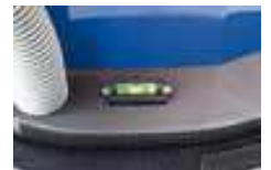
Vodováha pro správné nastavení brusné hlavy.
